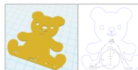
図5:Cathirdでの3Dプリンタ用のプレビュー画面(左)とレーザー加工機用のプレビュー画面(右)
